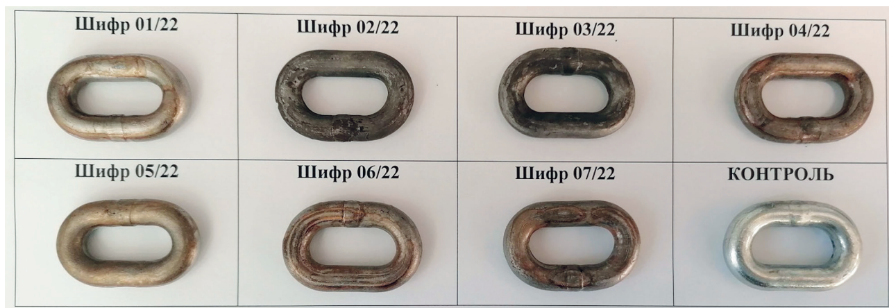
Рис. 5. Изменение поверхности звеньев стальной цепи Fig. 5. Changing the surface of steel chain links
