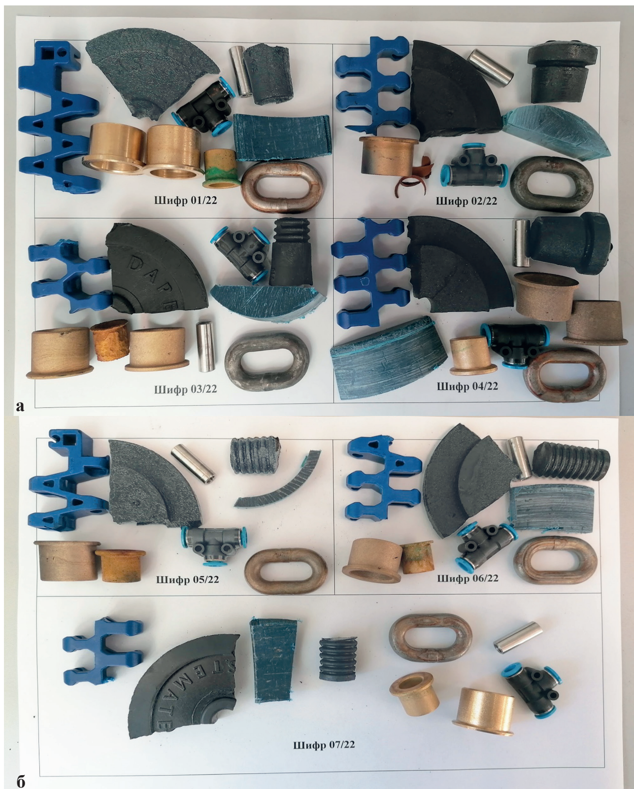
Рис. 2. Внешний вид тест-объектов через 1 ч воздействия дезинфектантов на основе НУК: а – шифр 01/22, 02/22, 03/22 и 04/22; б – шифр 05/22, 06/22 и 07/22
