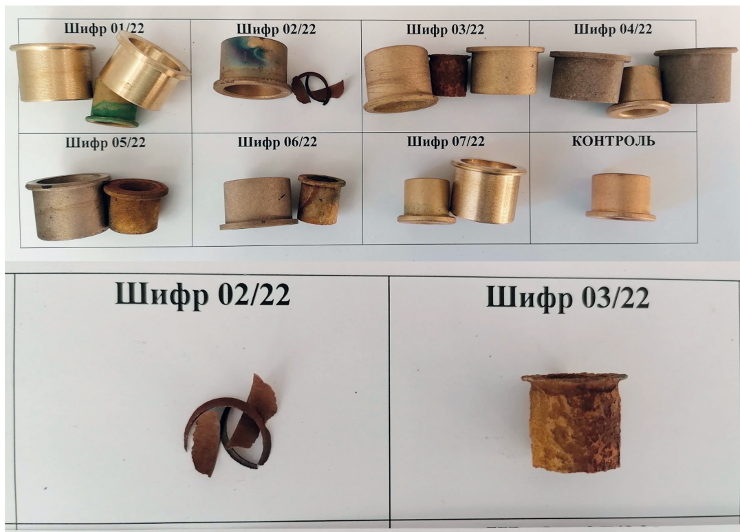
Рис. 4. Изменение структуры латунных втулок Fig. 4. Changing the structure of brass bushings
